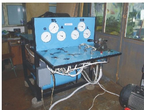
Stand de verificare a calității distribuitorilor pneumatice ale frânelor vagoanelor de cale ferată utilizând tehnica de calcul
