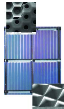
Structura de 4 celule solare cu suprafața texturată (centru). Tipuri de suprafețe texturate: fagure (sus) și piramida (jos)
