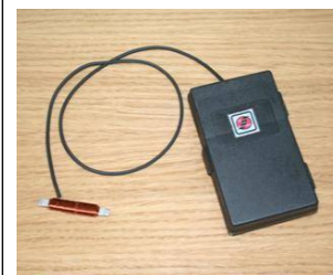
Dispozitiv încărcare acumulatori, pe bază de materiale magnetostrictive. Funcționarea acestuia se bazează pe conversia energiei mecanice (vibrații, oscilații) în energie electrică.
